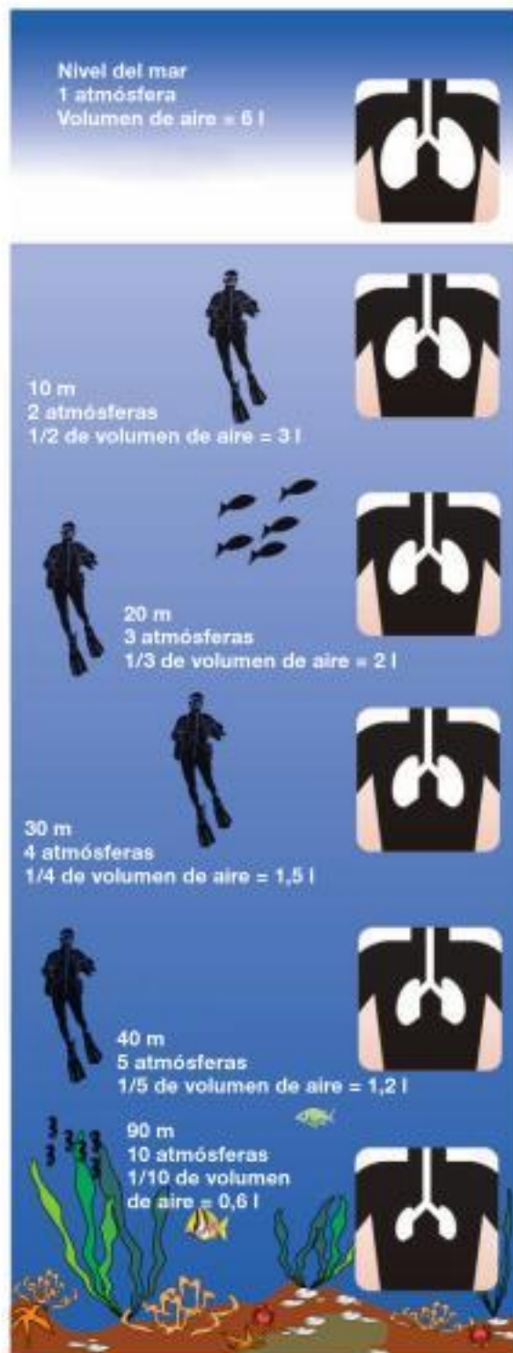
Figura 11.6 Relación entre la profundidad de la inmersión en el agua y el volumen de aire en los pulmones de un buzo.
