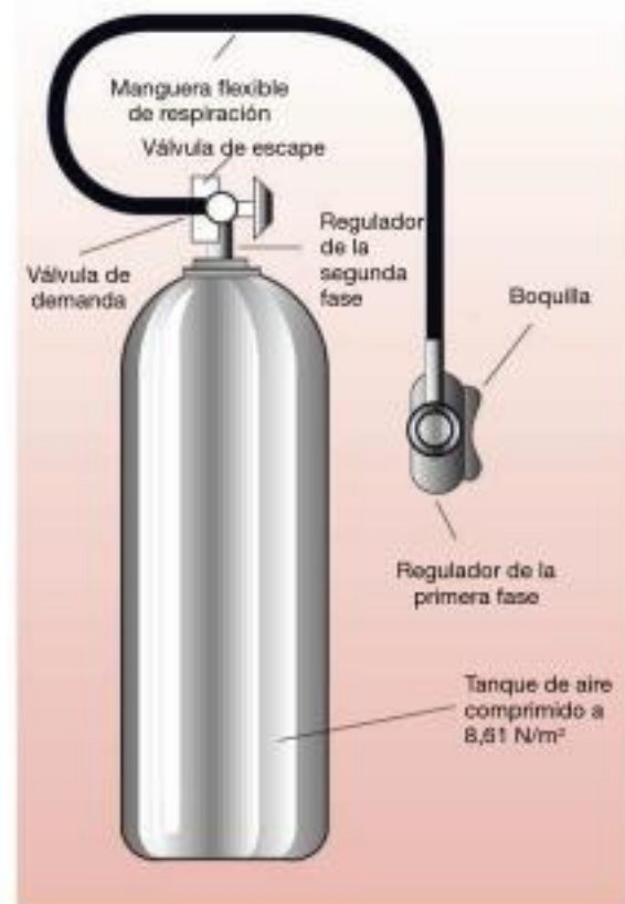
Figura 11.8 Escafandra de demanda de circuito abierto. Cuando el buzo toma aire de la bombona, el regulador ajusta la presión del gas a la del agua circundante, para permitir así que el buceador inhale.
