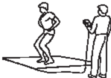
Figura 24. El ergojump de Bosco.
