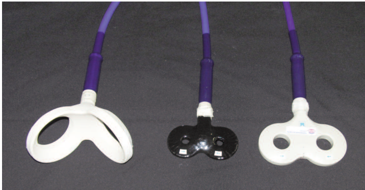
Figura 2.12. Diferentes tipos de bobina: de derecha a izquierda, bobina en forma de 8 de 9 cm de diámetro cada círculo, bobina en forma de 8 de 7 cm de diámetro cada círculo y bobina cónica. La primera de ellas es la más utilizada debido a su mejor focalidad, la segunda se utiliza para protocolos que requieren posicionar dos bobinas sobre la cabeza del sujeto, y la tercera es la más idónea para estimular el cerebelo y las zonas motoras correspondientes a la musculatura del miembro inferior. Elaboración propia.
